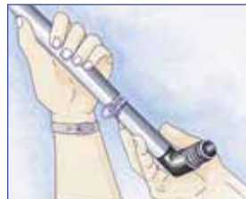
LPE-cső szerelésekor használjunk csőszorító bilincset, majd...
