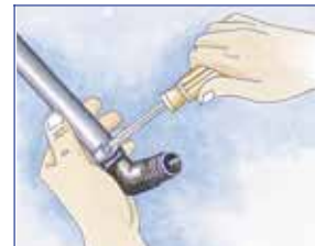
... a bordás idom behelyezése után szorítsuk meg azt.
